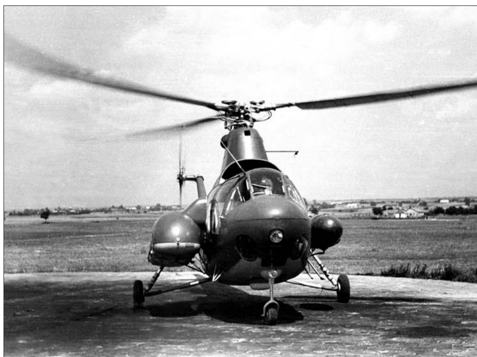
SM-1 w rzadkiej wersji sanitarnej z jedną gondolą i dodatkowym zbiornikiem
